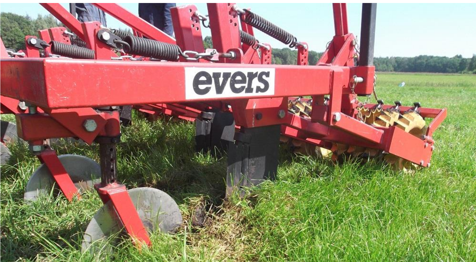
Foto: Een molpoot doorbreekt de versturende laag.
